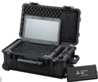
Das portable und auf das Werkeumfeld angepasste System bietet eine prozesssichere Anwendung. Baureihenspezifische Adapter ermöglichen eine einfache und reproduzierbare Befestigung der Beschleunigungssensoren an den Lagergehäusen eines Radsatzes. Die Messdaten werden durch das RSLG-DG erfasst und verarbeitet. Durch die vollautomatisierte Analyse stehen die Prüfergebnisse unmittelbar und eindeutig visualisiert auf dem Bedien-Laptop zur Verfügung.
