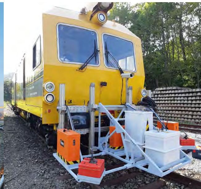
3D Erfassung der Oberfläche 360° Bilderfassung der Umgebung Blick unter die Schiene
