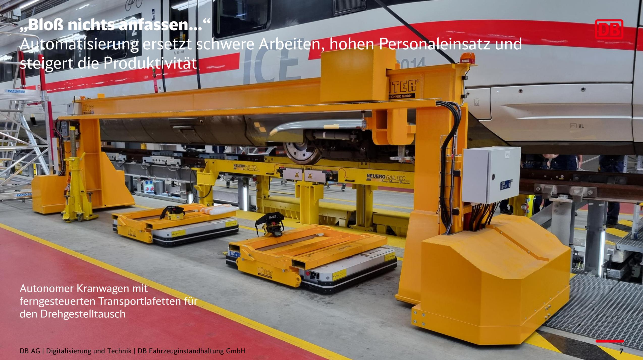
Autonomer Kranwagen mit ferngesteuerten Transportlafetten für den Drehgestelltausch
