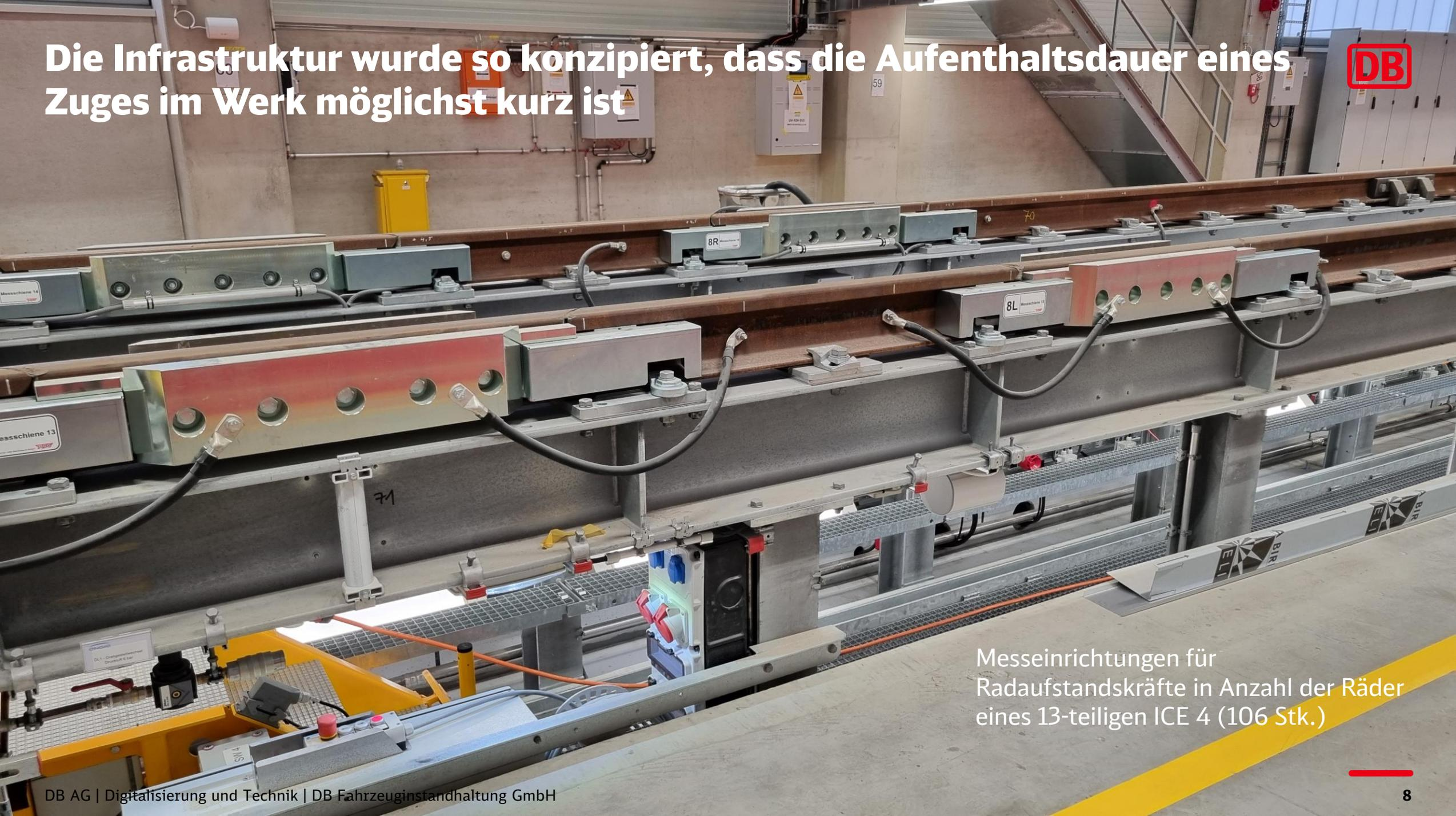
Messeinrichtungen für Radaufstandskräfte in Anzahl der Räder eines 13-teiligen ICE 4 (106 Stk.)
